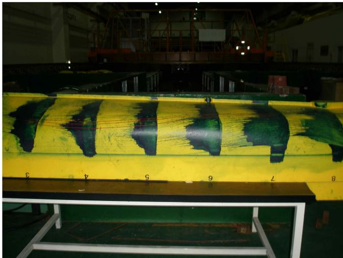
Fig. 빌지킬 부착을 위한 유선 시험 결과(붉은 선이 빌지킬의 부착 마크임)
